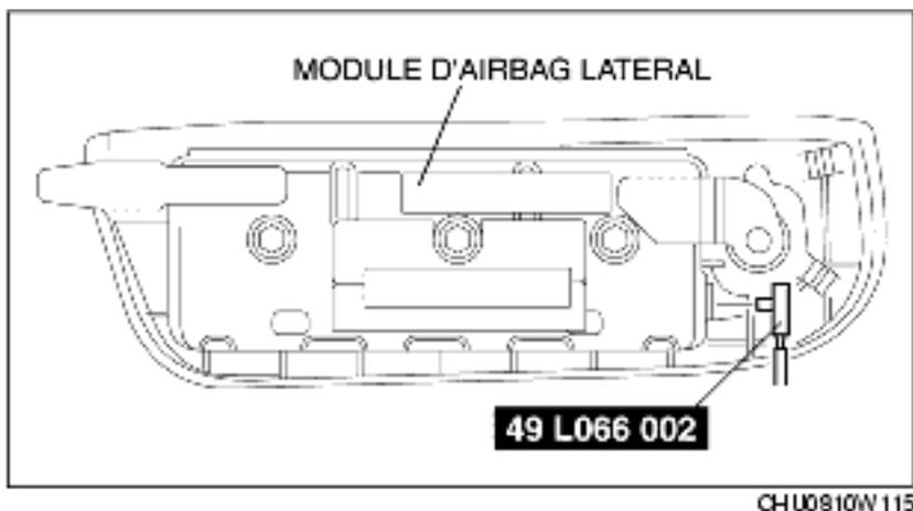
3. Placer la surface rembourrée du module d'airbag latéral vers le centre du pneu, comme indiqué dans l'illustration. Pour fixer le module d'airbag à la roue de pneu, faire passer un câble (section transversale de **1,25 mm<sup>2</sup> {0,002 in<sup>2</sup>} ou plus**) à travers le pneu et autour des supports **au moins 4 fois**.
