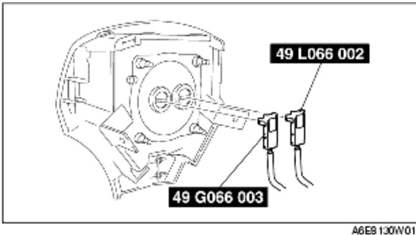
3. Placer le module d'airbag côté conducteur au centre de la roue de pneu, surface de rembourrage vers le haut. Pour fixer le module d'airbag à la roue de pneu, faire passer un câble (section transversale de **1,25 mm<sup>2</sup> {0,002 in<sup>2</sup>} ou plus**) à travers la roue et les orifices de fixation de boulons du module d'airbag **au moins 4 fois**.
