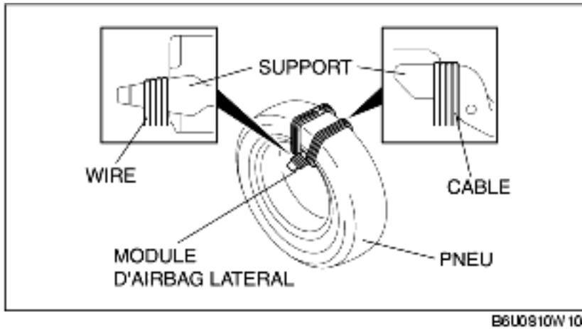
4. Empiler le pneu auquel le module d'airbag latéral est fixé au-dessus de deux pneus sans roues. Empiler un pneu sans roue au-dessus du pneu auquel le module d'airbag latéral est fixé, et empiler un autre pneu avec roue tout au-dessus.
