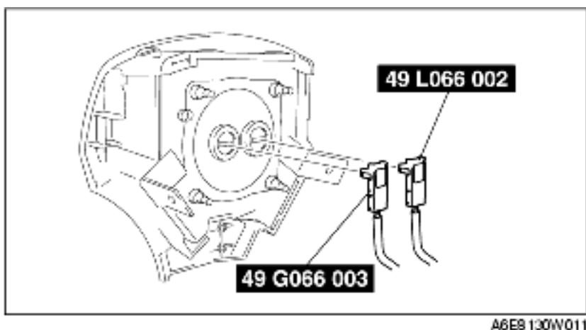
3. Reposer le module d'airbag côté conducteur. (voir la section [DEPOSE/REPOSE DE MODULE D'AIRBAG COTE CONDUCTEUR.](#))
