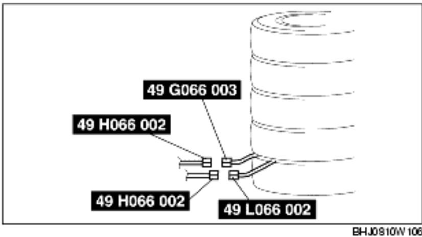
7. Brancher les deux outils **SST** (outil de déploiement) sur la batterie. Brancher l'attache rouge de l'alimentation sur la borne positive de la batterie, et l'attache noire sur la borne négative de la batterie.
