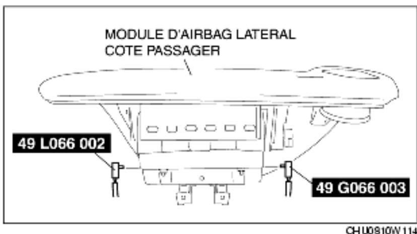
4. Placer la surface rembourrée du module d'airbag côté passager vers le centre du pneu, comme indiqué dans l'illustration. Pour fixer le module d'airbag à la roue de pneu, faire passer un câble (section transversale de **1,25 mm<sup>2</sup> {0,002 in<sup>2</sup>} ou plus**) à travers le pneu et autour des boulons du module d'airbag **au moins 4 fois**.
