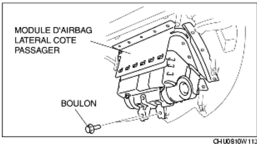
3. Brancher les outils **SST** (faisceau d'adaptateur) au module d'airbag côté passager, comme décrit sur la figure.
