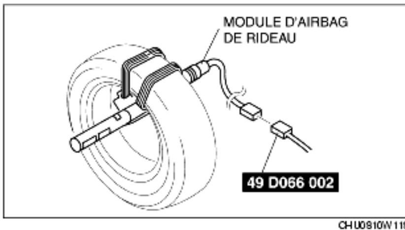
5. Empiler le pneu auquel le module d'airbag de rideau est fixé au-dessus de deux pneus sans roues. Empiler un pneu sans roue au-dessus du pneu auquel le module d'airbag de rideau est fixé, et empiler un autre pneu avec roue tout au-dessus.
