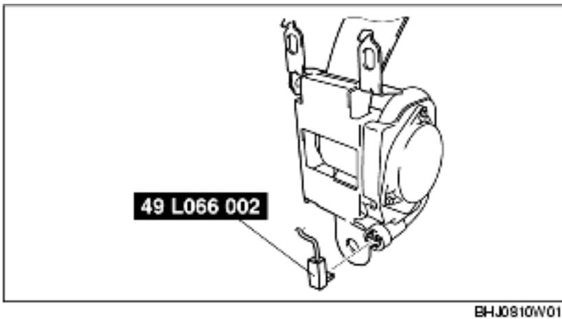
3. Placer la ceinture de sécurité à prétendeur à l'intérieur du pneu, et l'y fixer en faisant passer un fil de fer (section transversale de 1,25 mm<sup>2</sup> {0,002 in<sup>2</sup>} ou plus) à travers le pneu et les orifices de fixation de boulons au moins 4 fois.
