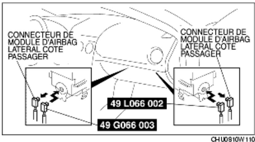
4. Brancher les outils **SST** (outil de déploiement) sur les outils **SST** (faisceau d'adaptateur).
