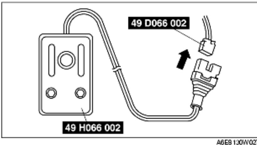
4. Brancher l'outil **SST** (outil de déploiement) sur la batterie. Brancher l'attache rouge de l'alimentation sur la borne positive de la batterie, et l'attache noire sur la borne négative de la batterie.
