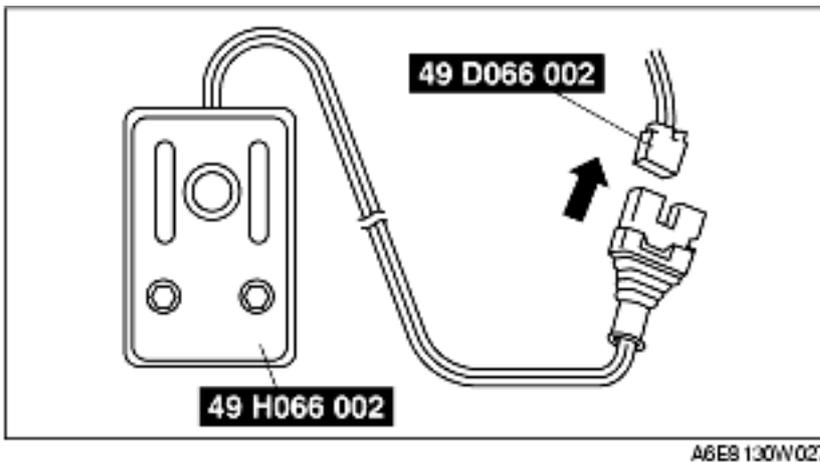
5. Brancher l'**outil SST** (outil de déploiement) sur la batterie. Brancher l'attache rouge de l'alimentation sur la borne positive de la batterie, et l'attache noire sur la borne négative de la batterie.
