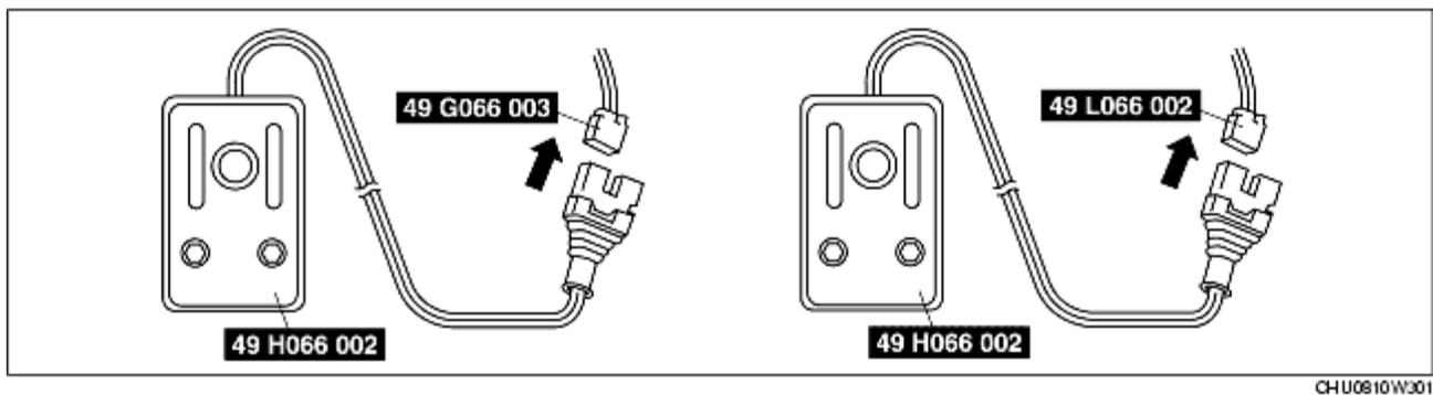
5. Brancher les deux outils **SST** (outil de déploiement) sur la batterie. Brancher l'attache rouge de l'alimentation sur la borne positive de la batterie, et l'attache noire sur la borne négative de la batterie.
