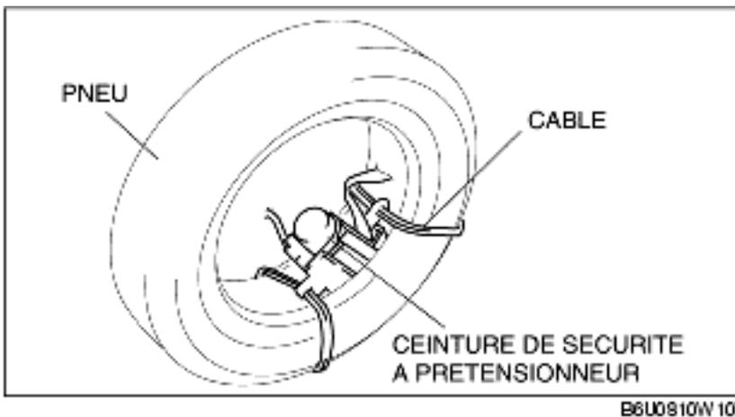
4. Placer le pneu auquel le prétendeur de ceinture de sécurité est attaché au-dessus de deux autres pneus sans roues. Empiler un pneu sans roue au-dessus du pneu auquel le prétendeur de ceinture de sécurité est attaché, puis empiler un autre pneu avec roue tout au-dessus.
