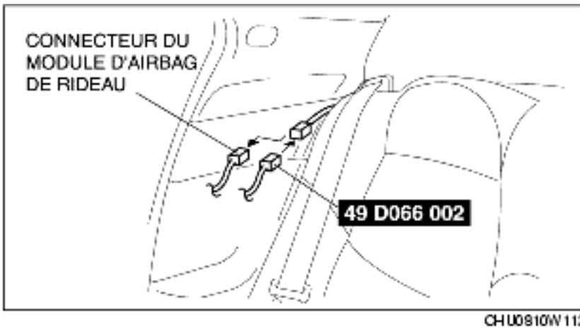
3. Brancher l'**outil SST** (faisceau d'adaptateur) au module d'airbag de rideau comme décrit sur la figure.
